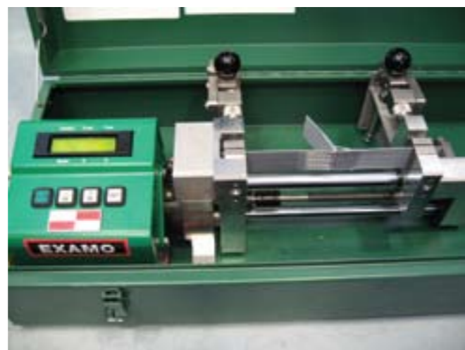
Рисунок 4.2.5 Проверка качества сварного шва при помощи Leister Examo.
