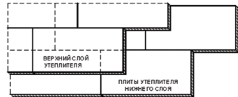
Рис. 2.2.2 Смещение плит утеплителя в соседних рядах и слоях.
