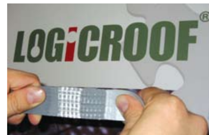
Рисунок 4.2.2 Когезионный разрыв сварного шва неармированной и армированной мембраны.
