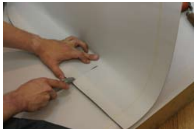
Сделать надрез, не доходя до сгиба 15 мм.
