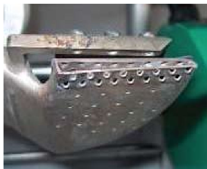
Рисунок 4.2.6 Насадка на сварочный автомат, разрушающая олигомерную пленку.
